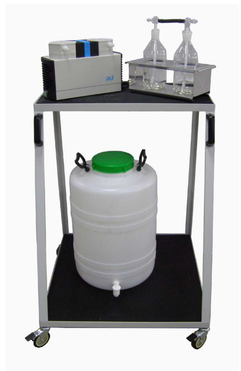
Bomba de vacío, Scrubber y bidón de 50 litros
