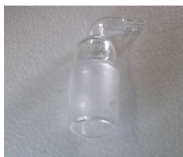
Tapón 29/32 con salida 10mm a 90°C
