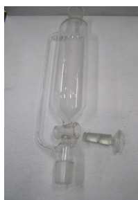
Embudo adición 250ml, presión compensada DIN29/32
