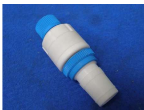
Guia para agitadores PTFE 29/32 Ø 10 MM Alta resistencia química Vacío bajo (5 mmHg) Presión (3-5psi) Sello de rodamiento de precisión de PTFE / PEEK / vidrio de alto rendimiento Manguito anti-batidor interno Código 1001788
