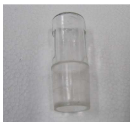
Tapón 29/32 ciego para embudo adición
