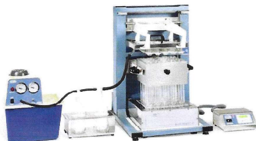
Bomba de recirculación "Scrubber" Bloque digestor
