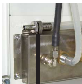
Válvula de vaciado del refrigerante
