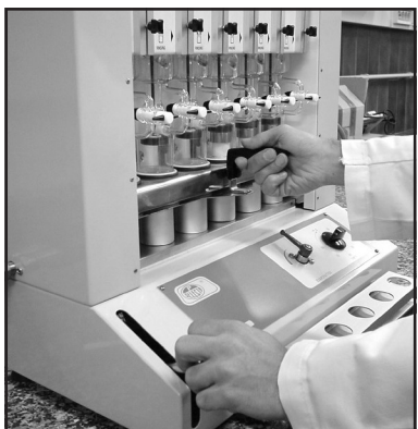
Colocación de los vasos al extractor.
