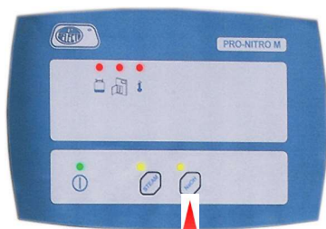
Adición manual del NaOH durante la destilación
