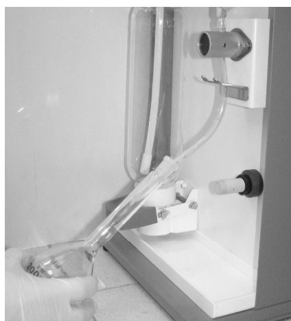
Posición del matraz para añadir destilado hasta conseguir el enrase
