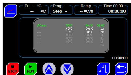
Fig 7.3.2. Pantalla de trabajo con un perfil de temperatura
