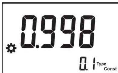
Fig. 5-10 Tipo de constante 0.1 y constante de célula 0.998
