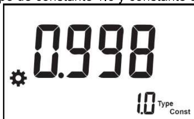
Fig. 5-9 Tipo de constante 1.0 y constante de célula 0.998
