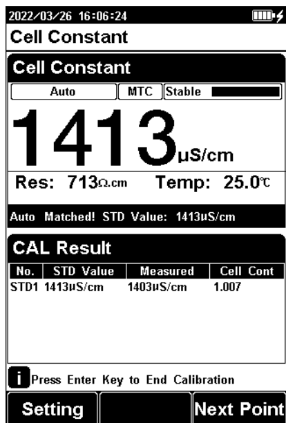
Imagen 5-4 Información sobre la calibración constante de la célula del electrodo
