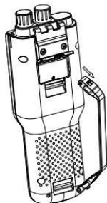
Imagen 4-4: Instalación de la correa
