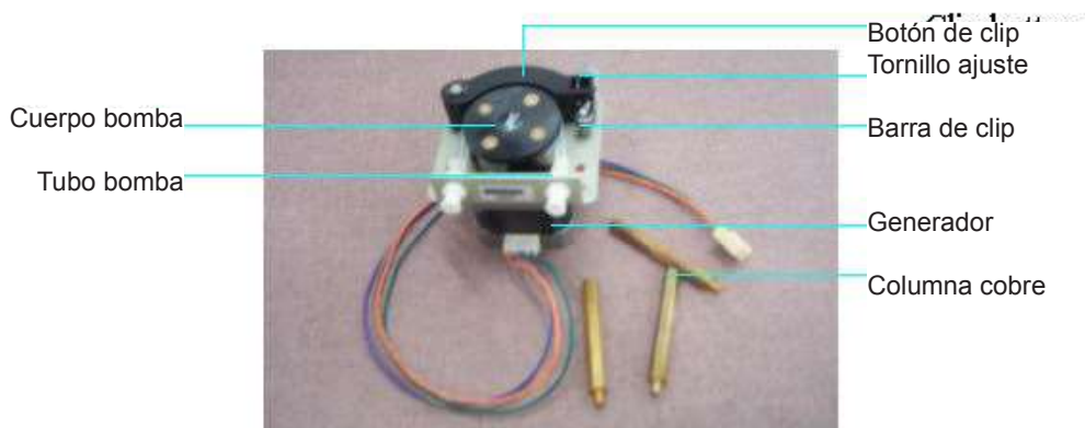
Figure 5.3 Bomba peristáltica.
