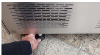
Bloqueo de ruedas en autoclaves de 150L
